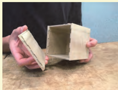
衛星に施された伝統技法「留形隠し蟻組接ぎ」
