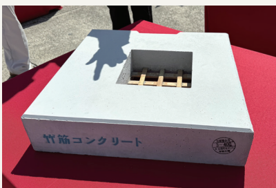
バイオマス燃焼副産物を活用した コンクリート2次製品として試作品を作成 (坂内セメント工業所さま提供)
