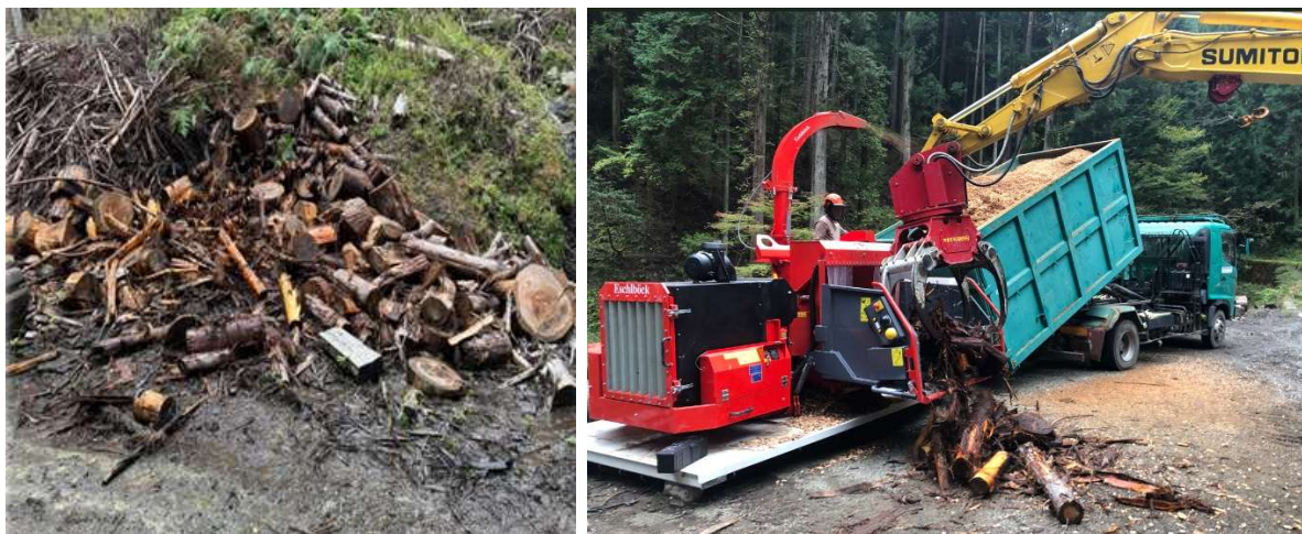
川股実証地の林地残材(左)、及び移動式チッパーを活用した林地残材の現地チップ化
