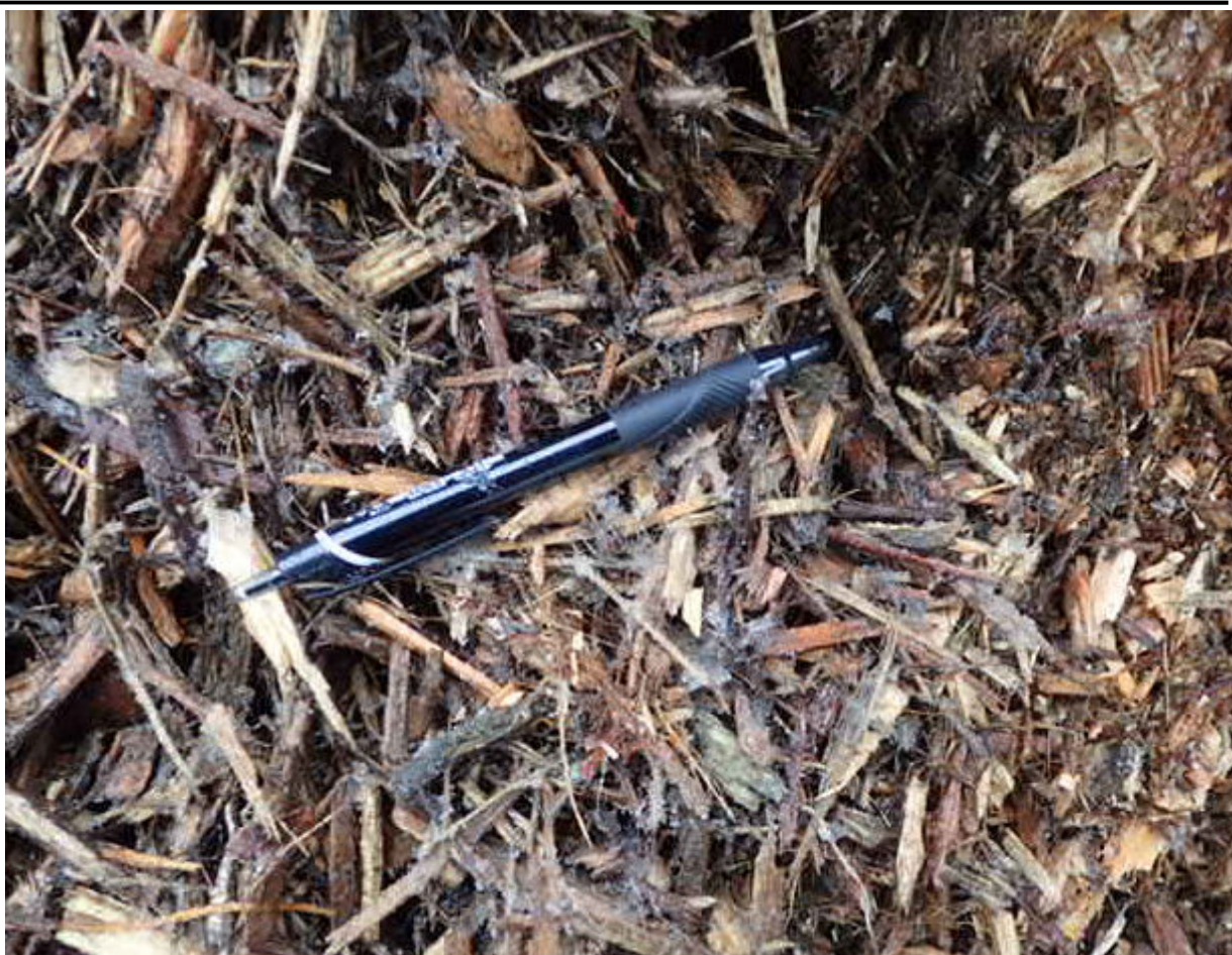
これが、BPT松阪木質バイオマス発電所が使う燃料だ。高知・グリーンエネルギー研の燃料と同様、だれも見向きもしない“粗悪な”枝葉や樹皮がメインのバイオマスだ。しかし、森林資源カスケード利用の最下段に位置して、お題目でなく真に森林資源の活用、地域林業振興に貢献できるバイオマス発電所の、本来あるべき姿がここにはある
