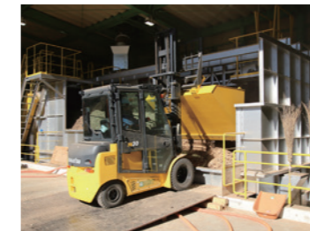
チップ定量フィーダ 燃料を燃焼室へ定量供給する機械です。
